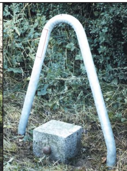
HFP Granitpfeiler 25 cm x 25 cm mit seitlichem Bolzen und Stahlschutzbügel
