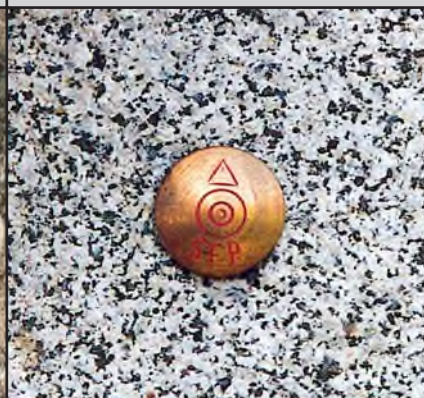
SFP Messingbolzen Ø 3 cm
